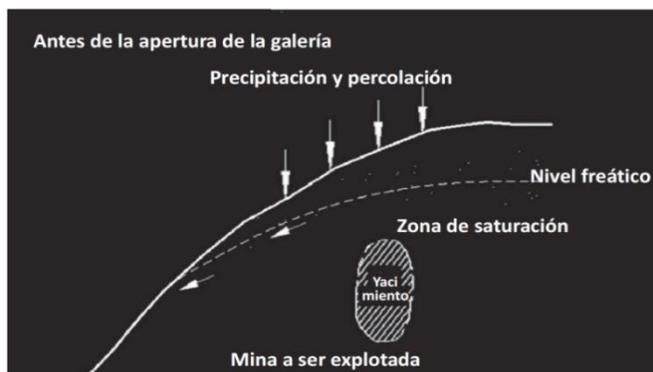
Figura 3. Conceptualización Antes de la Apertura de la Labor Subterránea
